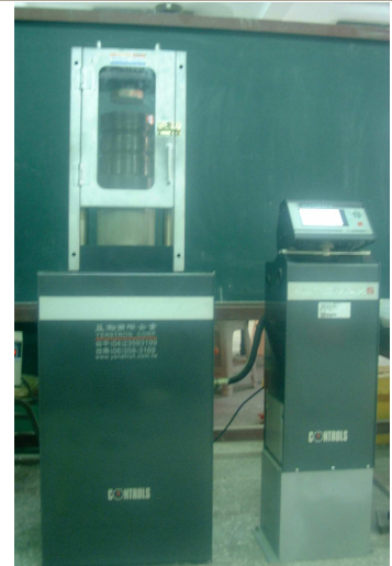
CONTROLS 30T 抗壓試驗機
